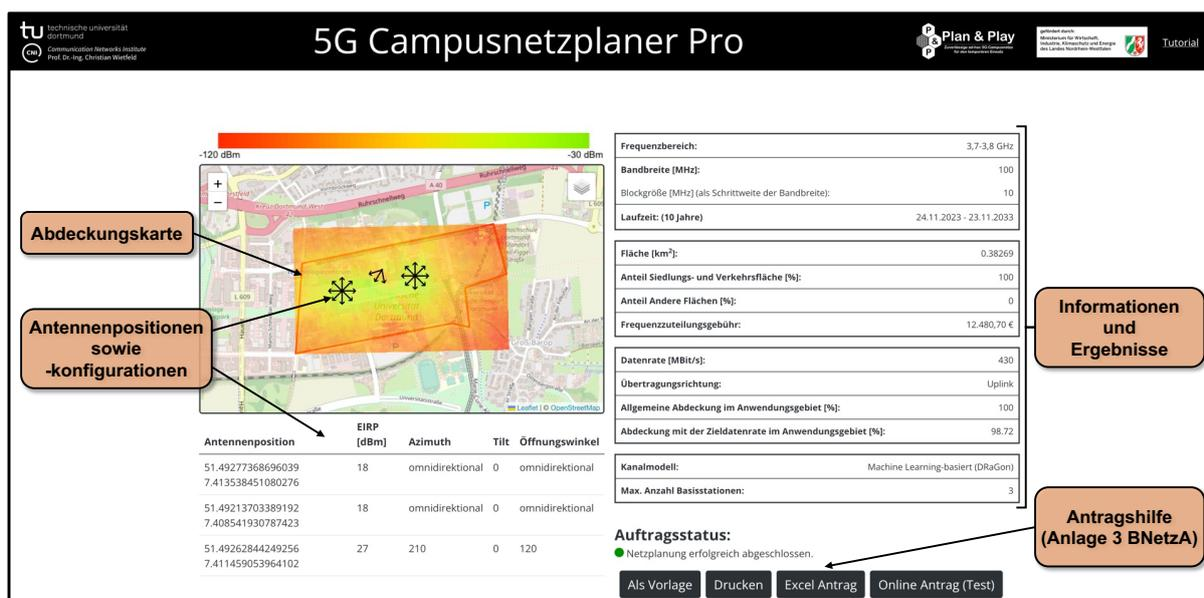
Abbildung 5: Auf der Ergebnisseite wird eine Abdeckungskarte, die empfohlenen Antennenpositionen und -Konfigurationen, sowie eine Antragshilfe für die Frequenzteilung bereitgestellt.
