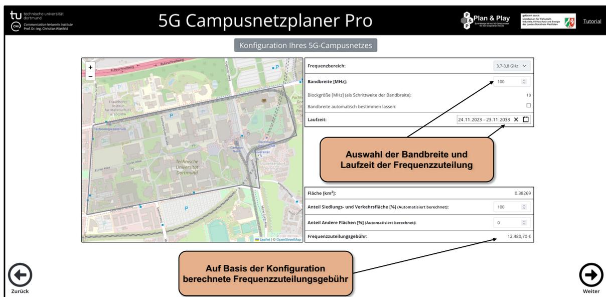
Abbildung 3: Im zweiten Schritt wird die Frequenzteilung konfiguriert, z.B. Bandbreite und Laufzeit. Auf der Basis wird dann eine Zuteilungsgebühr abgeschätzt. Die Bandbreite kann auch automatisch auf Basis der nachfolgenden Anwendungsdefinition berechnet werden.
